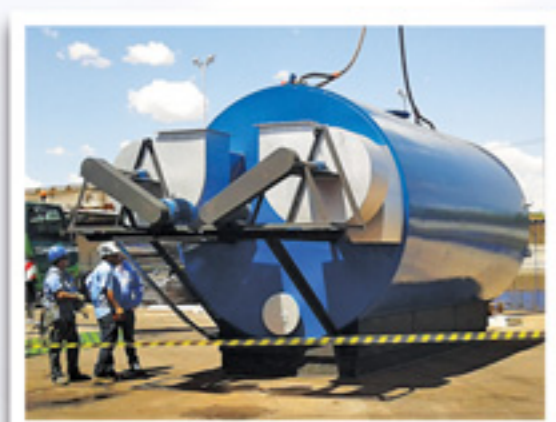
Montagem Caldeira à Lenha
